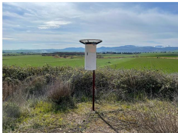
Figura 8: Postazione di monitoraggio D3: DEPOBULK per campionamento di Microinquinanti organici e Metalli pesanti
