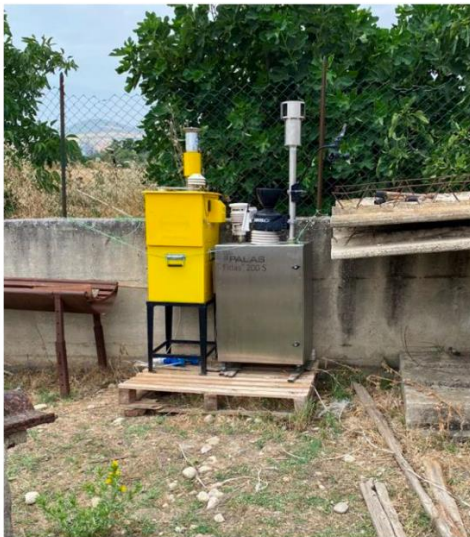
Figura 3: Postazione di monitoraggio A2: LIFETEK PMS Sistema sequenziale per il campionamento delle polveri sottili; Fidas 200 analizzatore real time polveri -OPC
